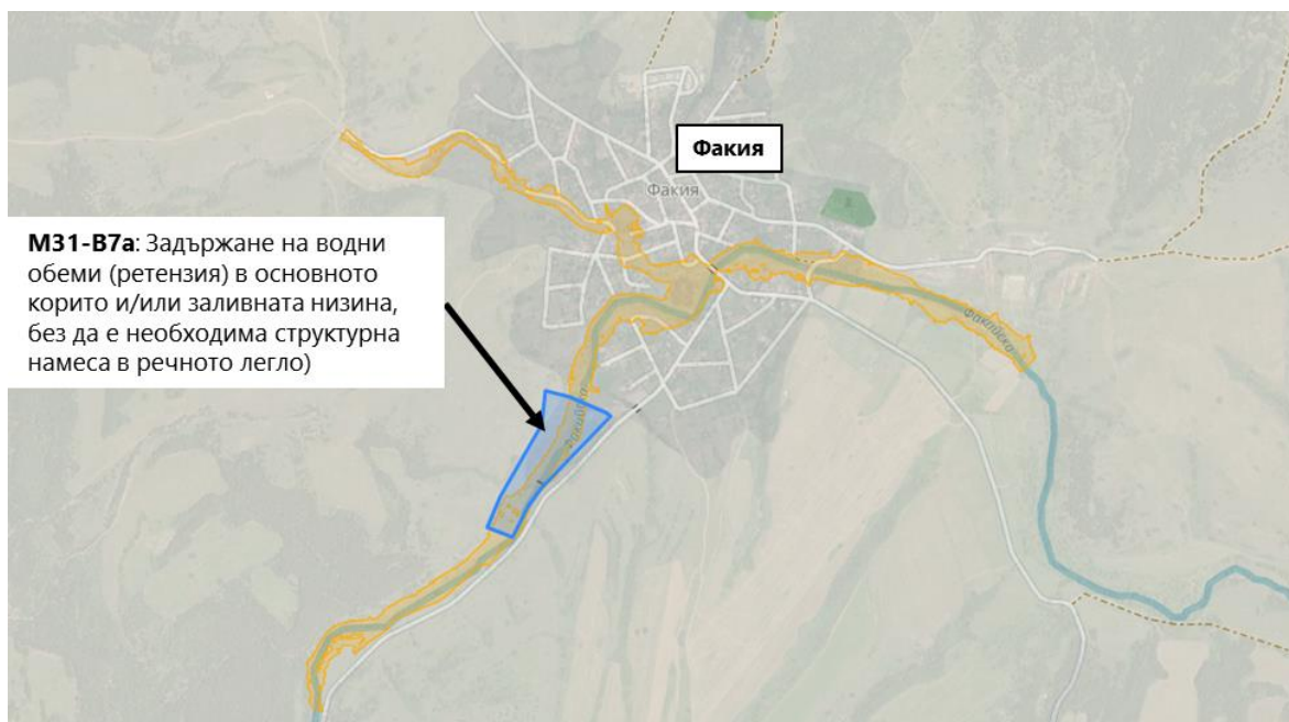
Фигура 1.3 Избрани мерки (в синьо) при обхват на наводнение с обезпеченост 1% (в оранжево)
