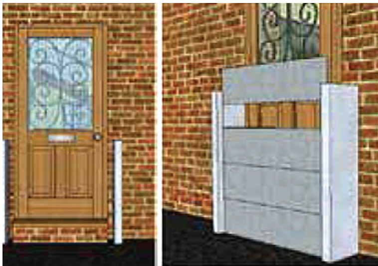
Водоплътна преграда срещу наводнения поставена пред външна врата
