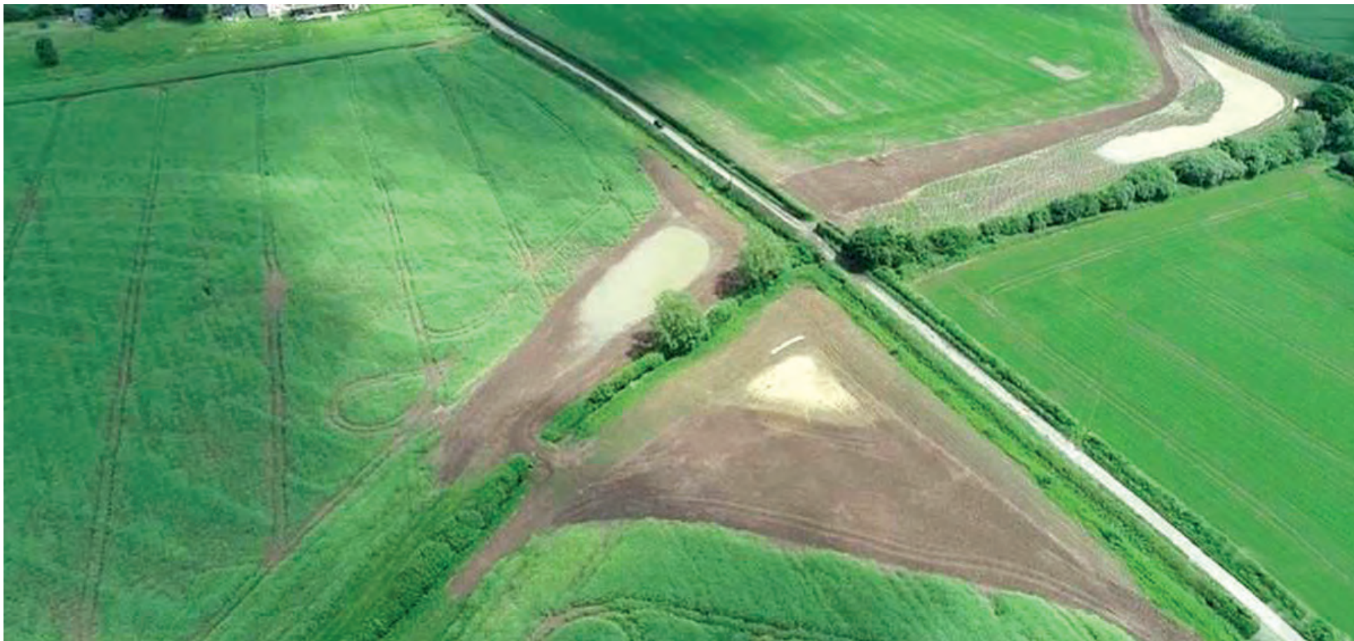
Препрофилиране на част от заливната равнина и повдигане на бреговете за отклонване и задържане на високите води. Източник: Evenlode Catchment Partnership/Kestrel Photography, UK
